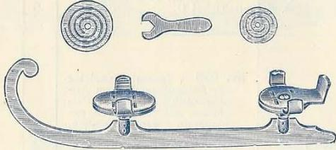
Nr. 632 I., Roland - Schlittschuhe mit verstärkten, gehärteten und verjüngt geschliffen. Läufern. Die Sohlen u. Absatzklammern bewegen sich in verdeckten Spiralscheiben und schliessen sich durch Drehung des an den Scheiben befindlich. Sechskants vermittelst eines Schlüssels u. bewirken eine sichere Befestigung . . . . .
